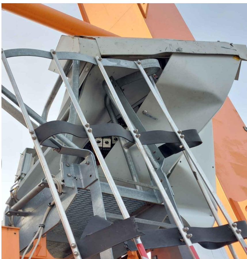
Slika 3: Poškodba elektro omare poz »E6« in dostopnih stopnic z hrbtno zaščito
